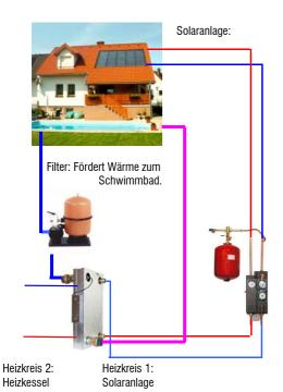
Bei den Hinteregger Schwimmbadwärmetauscher handelt es sich um einen verlöteten Plattenwärmetauscher, welcher besonders für den Einsatz bei Schwimmbädern bis zu einer Größe von 50 m² optimiert ist.
