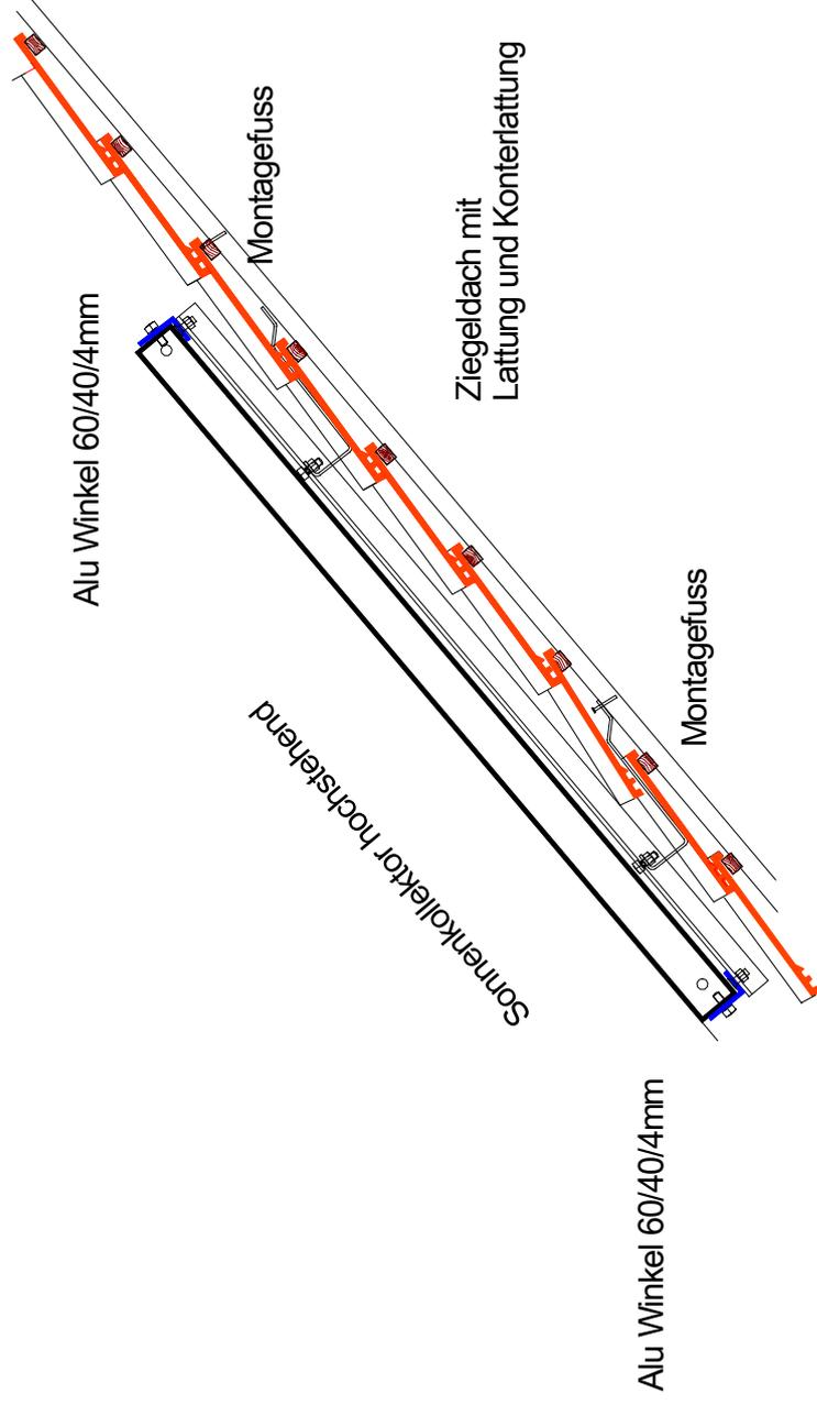
Kollektorbefestigung erfolgt mit Schrauben M8 auf Aluwinkel 60/40/4mm in vorgebohrten Löchern
